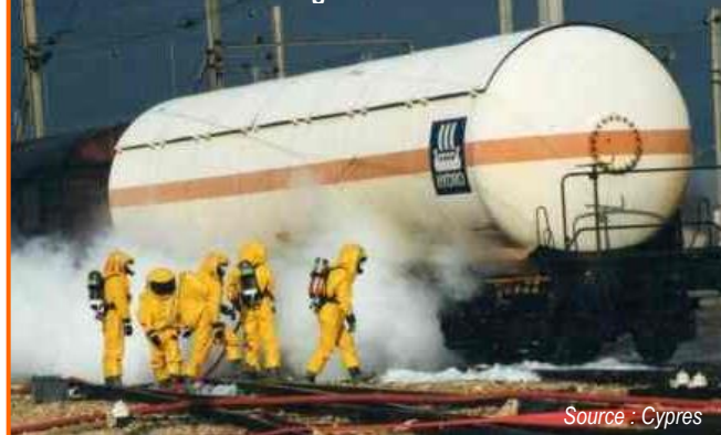
Fuite de chlore sur un wagon-citerne
